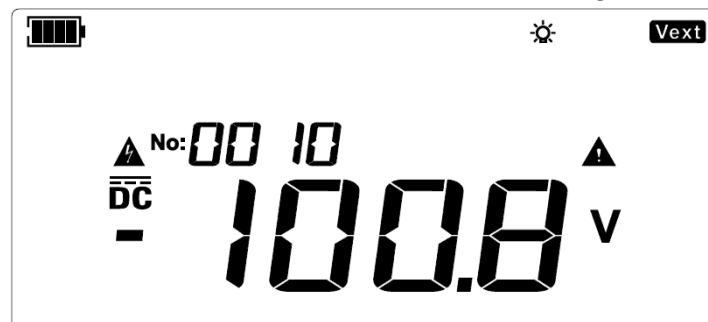
Figure 9.24 Mesure de la tension DC négative
